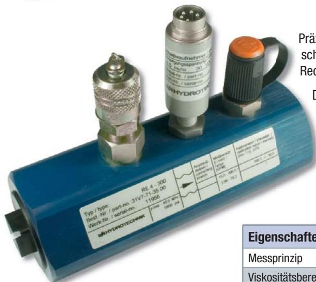
Präzise und tausendfach bewährte Messturbinen mit Innengewinde-Anschluss nach DIN ISO 228, wahlweise erhältlich mit digitalem (Frequenz, Rechtecksignal) oder analogem (4 ... 20 mA) Ausgangssignal.
