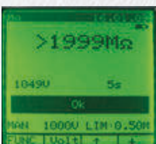
Isolationsmessung mit 1000V DC
