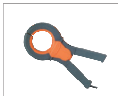
HT96U Zange bis 1000 AC 3 Messbereiche: 1/100/1000 A AC
