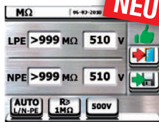
AUTO Isolationsmessung mit L/N und L/PE Ergebnisanzeige
