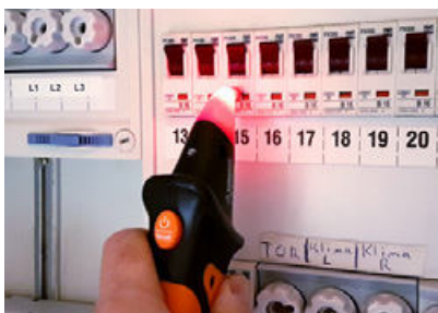
Rote LED: Sicherung gehört nicht zum gesuchten Stromkreis.
