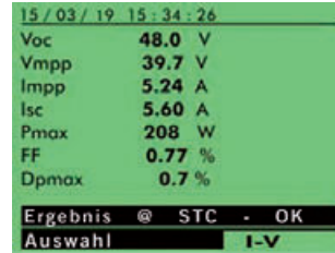
Messwertergebnis in Funktion I-U Kennlinienmessung
