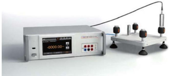
Üblicherweise erfordern die Druckkontroller die Verwendung einer Stickstoffflasche als Gasversorgung. Dies macht es schwierig, den Regler zu bewegen, ohne eine andere Gasflasche verbinden zu müssen. Die Additel 780er Serie ist einzigartig, da sie optional eine elektrische Pumpe haben, mit der Drücke bis 70 bar erzeugt werden können ohne zusätzliche Gasflasche.
