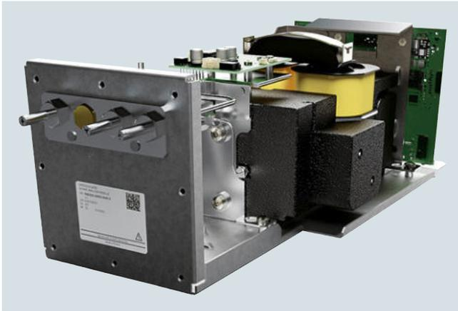
Die Funktion des OXYMAT 7 Moduls beruht auf dem paramagnetischen Wechseldruckverfahren und wird zur Messung von Sauerstoff in Gasen eingesetzt.
