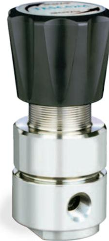
Die ICS Serie 44-2200 sind kompakte, leichte, einstufige Reinstgasregler für Spezialgase, brennbare Gase und Industriegase bei Durchflüssen bis 141 slpm. Die diffusionsdichte Metallmembranabdichtung stellt Gasreinheit und Dichtigkeit sicher.
