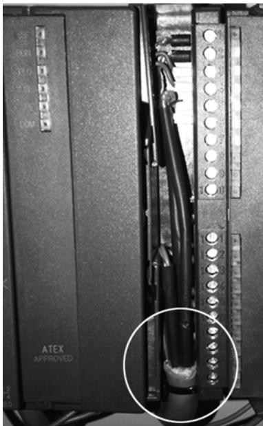
Bild 5-7 Richtige Montage der Messaufnehmer-Kabelabschirmung
