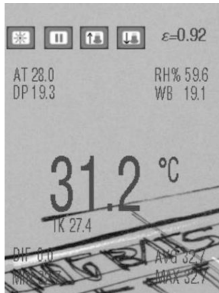
Abb. 26: IR-Temperaturmessung mit eingebildeten Photo-Kamera
