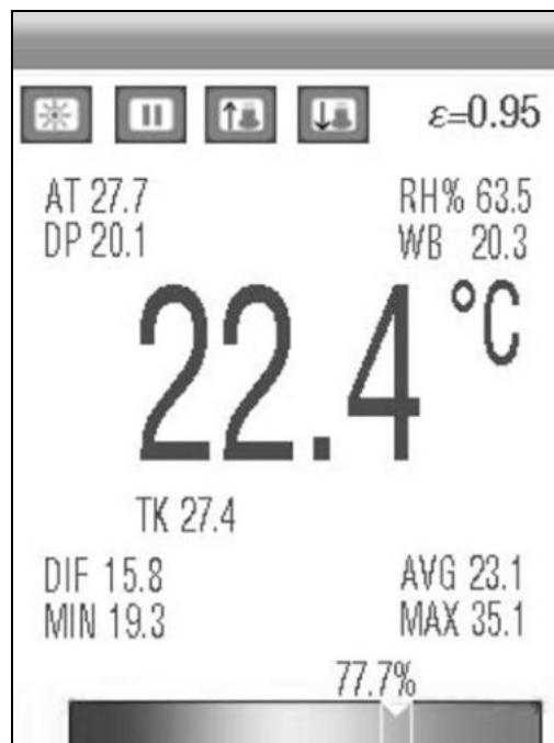
Abb. 30: Temperaturmessung des Taupunktes
