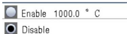
Abb. 16: Menü Einstellung der maximalen Alarmgrenze
