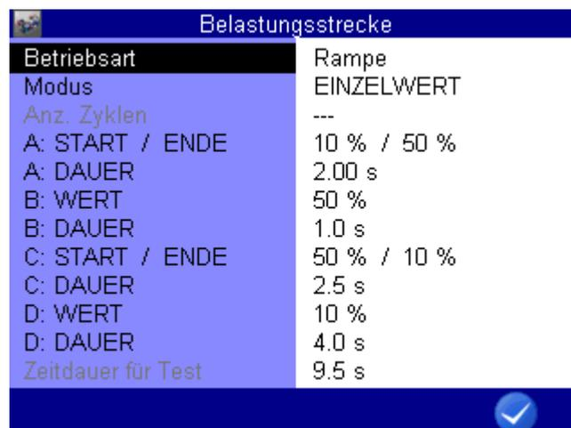
In dieser Betriebsart wird eine Rampe abgefahren, die mit vier Bereichen definiert werden kann.
