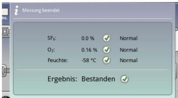
Messergebnisse werden automatisch mit den definierten Grenzwerten verglichen und bei Bestehen wird ein OK-Symbol ausgegeben.
