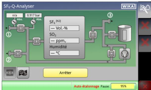
**i** Si l'instrument de mesure a connu de fortes différences de température ou si un gaz très sec doit être mesuré, l'instrument doit être allumé au moins une heure avant la mesure.
