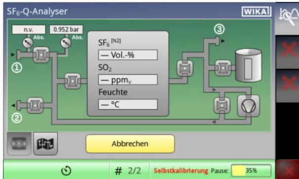
**i** Wenn das Messgerät große Temperaturunterschiede erfahren hat oder sehr trockenes Gas gemessen werden soll, muss das Gerät mindestens 1 Stunde vor der Messung eingeschaltet werden.
