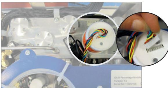
3. Dévisser le capteur dans le sens inverse à celui des aiguilles d'une montre.
