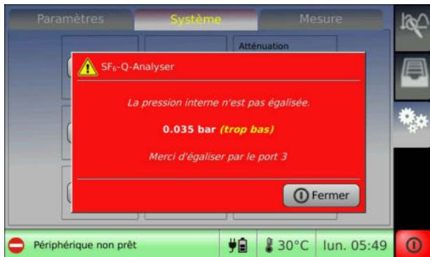
Pour la compensation de pression, connecter un sac de récupération de gaz avec le gaz souhaité (sous pression atmosphérique, max. 1.200 mbar abs. ou 200 mbar rel.) à la sortie prévue pour un sac de récupération de gaz ③.
