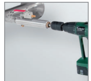
Anbohren unter Druck mit der Bohrvorrichtung
